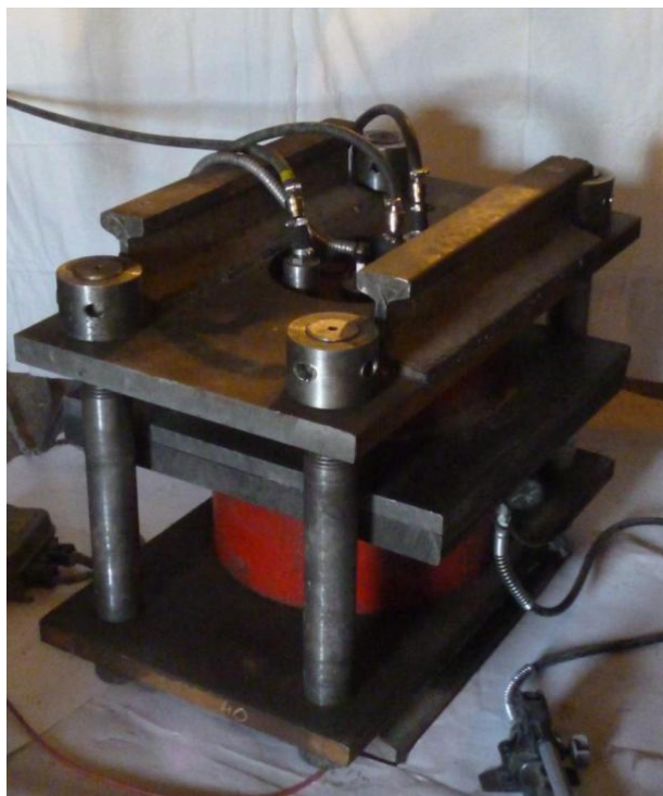
Рис. 3. Экспериментальное устройство для газовой штамповки
