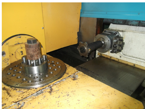
Рис. 5. Экспериментальная схема обработки и общий вид наладки на пятикоординатном обрабатывающем центре с ЧПУ модели MC 032:
